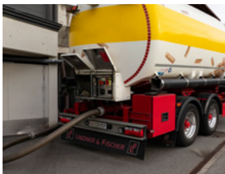
Nachhaltiger Nachschub – Pellet-anlieferung für den 350 kW Kessel.
