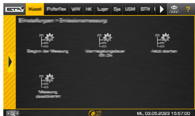
Abb. 2-79: Einstellungsfenster der Emissionsmessung
