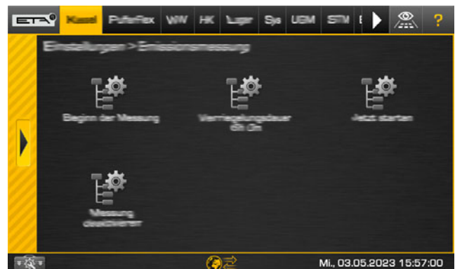
Abb. 2-80: Einstellungsfenster der Emissionsmessung
