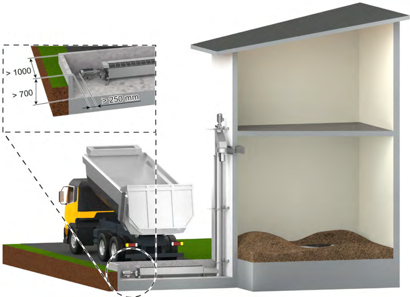
Abb. 5-4: Senkrechtschnecke mit Schleuder
